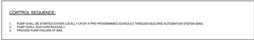
**8 DCW RECIRC. PUMP DHWR-1 CONTROL DIAGRAM**
